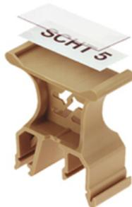
Le support de repérage de groupe **SchT 5 S** est directement encliqueté sur le rail TS 32 (rail G) ou sur le rail TS 35 (rail chapeau). Le repérage du bornier peut ainsi être réalisé indépendamment des bornes et du type de borne.
