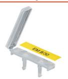
Le repère pour équerre de blocage EM 8/30 est adapté au repérage des équerres de blocage WEW 35/2 et ZEW 35/2. Il sert également au repèrage de groupe des blocs de jonction de la série W. L'EM 8/30 peut être équipé d'étiquettes ESO 7 et ESO 7P. L'enveloppe transparente qui se referme permet un changement facile d'étiquette et assure une bonne protection du marquage contre les agressions extérieures.
