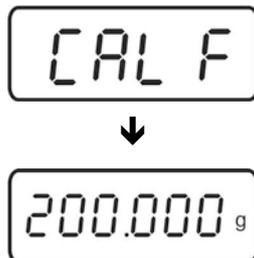
En cas d’erreur d’ajustage ou d’un faux poids d’ajustage apparaît „**CAL E**“. Répétez l’ajustage.
