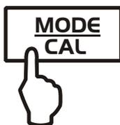
⇒ Décharger le plateau de la balance et appeler de façon répétée la touche **MODE** jusqu'à ce que „PtArE“ apparaisse en clignotant.
