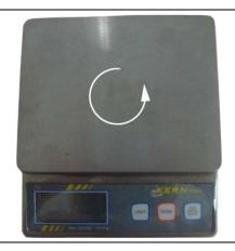
⇒ Débloquer le plateau de pesée la faisant tourner dans le sens de la flèche.
