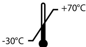
Limitation de température avec indication de la limite inférieure
