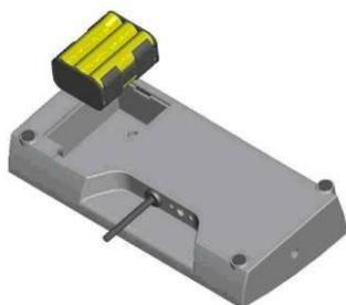
⇒ Veiller à ce que les piles soient insérées dans le sens correct
