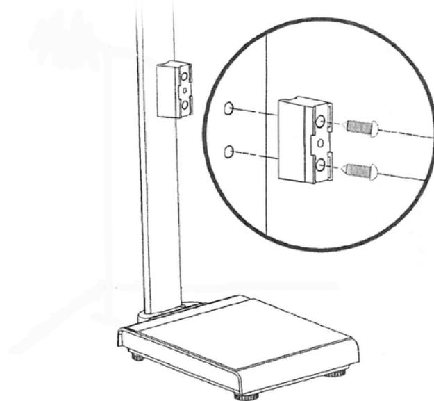
Vissez la fixation par 2 vis au pied de la balance dans les douilles taraudées qui s'y trouvent.
