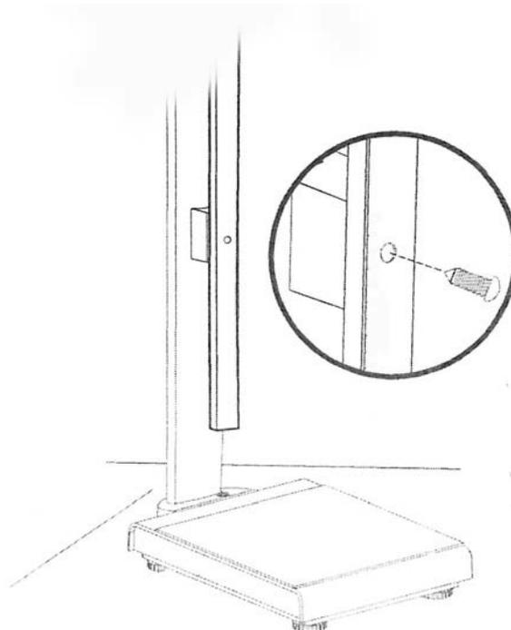
Déployez la toise de mesure de la taille et vissez-la à demeure à la fixation par la vis attenante au trou inférieur.
