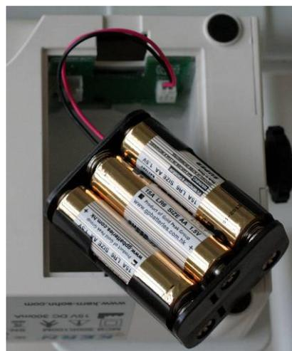
⇒ Insérer le support de batteries avec les batteries insérées dans l'appareil d'affichage
