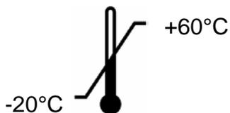
Limitation de la température avec l'indication de la limite inférieure et supérieure)
