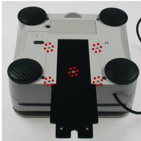
Pour le démontage retirer la tôle de montage par desserrage des vis marquées. L'appareil d'affichage est ensuite susceptible d'être librement installé.
