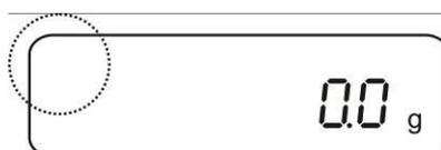
Lorsque l'affichage de la stabilité apparaît sur l'afficheur [o] la balance se trouve dans un état stable. A l'état instable l'affichage [o] disparaît.
