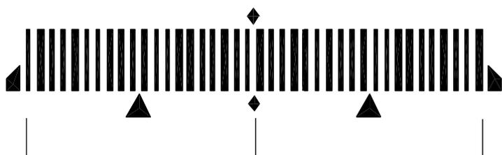
Pas de charge sur le plateau    Moitié de la charge maximale    Charge maximale
