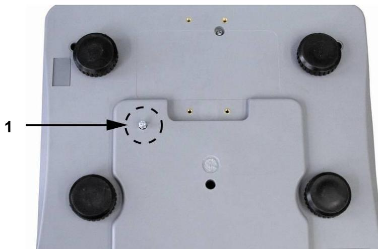
Pour dévisser la protection pour le transport, dévissez la vis de transport [1] en la dévissant dans le sens contraire des aiguilles d'une montre.
