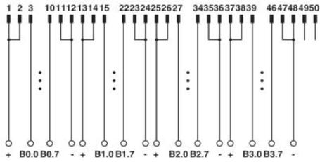
Schéma de connexion UM 45-FLK50/PLC
