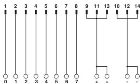
Schéma de connexion UM 45-FLK14/PLC
