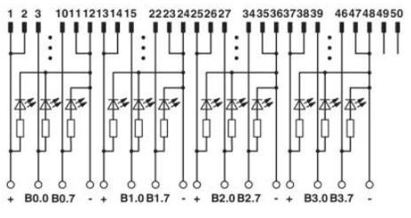
Schéma des connexions FLKM 50/LA/PLC
