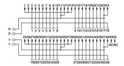
Schéma des connexions FLKM 50-PA-AB/1756/IN/EXTC
