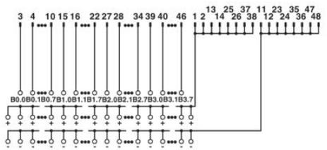
Schéma des connexions FLKMS 50/32IM/PLC, ...50/32IM/
