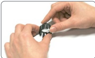
4. Replacez l'insert dans l'oculaire. Selon le type d'oculaire, il faut appuyer fermement sur l'insert ou le faire tourner dans le sens des aiguilles d'une montre.
