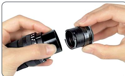
5. Insérez l'oculaire dans le tube oculaire.
