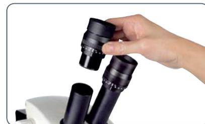
6. Pour orienter les réticules, tournez l'oculaire dans le tube oculaire.
