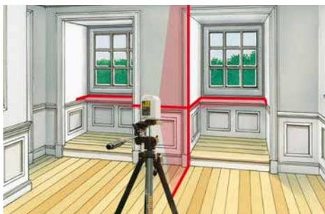
– **Les 2 lignes laser bien visibles** sont idéales pour l'alignement de carrelages, de supports, de fenêtres, de portes, etc.
