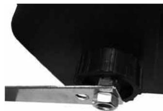
1. Dévissez la manette d'embrayage (environ 2 tours dans le sens inverse des aiguilles d'une montre) et posez la manivelle sur le pivot de la manette. Un des deux écrous doit ainsi des trouver sous la manette, et l'autre au-dessus.
