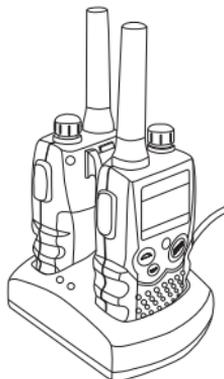
Le courant de charge de ce chargeur est ajusté de façon invariable à une valeur d'env. 50 mA ou 100 mA. Pour cette raison, le temps de charge varie selon le nombre d'accus à charger (un ou deux appareil/s radio) ainsi que l'état de charge de l'accu/des accus.
