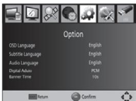
Ouvrez le menu principal avec **MENU** et sélectionnez [option]. Le menu propose plusieurs options de réglage pour la langue OSD, mais aussi des sous-titres et audio. Sélectionnez une option et appuyez sur ◀ / ▶ pour effectuer le réglage. Appuyez sur **EXIT** pour quitter le menu.
