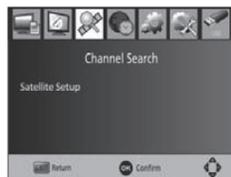
Ouvrez le menu principal avec **MENU** et sélectionnez [recherche]. Le menu propose plusieurs options de réglage. Sélectionnez-en une et appuyez sur **OK** ou sur **◀/▶** pour effectuer le réglage.
