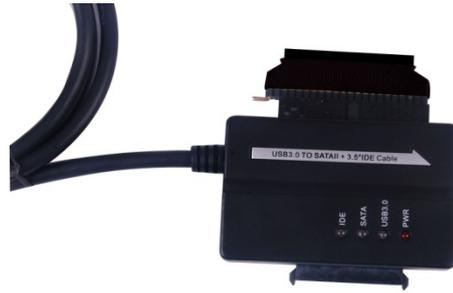
2. Veillez à ce que l'adaptateur du disque dur 2.5" soit raccordé au connecteur du disque dur IDE 3,5", dans le bon sens. Vous devez disposer du disque dur 2,5" pour le connecter à l'adaptateur de disque dur 2,5". Vous devez disposer d'un répartiteur d'alimentation (4P à 2P) pour le connecter à l'aide du câble USB 3.0 à SATA & IDE et l'adaptateur de disque dur 2,5".
