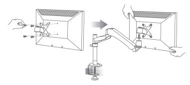
Utilisez la clé M3 pour resserrer ou desserrer le système de balancier.
