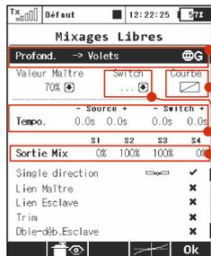
3. Pour modifier le mixage, il suffit de sélectionner la combinaison et d'appuyer sur la touche „F4 (Edit.er)” pour aller dans le menu avancé du mixage sélectionné.
