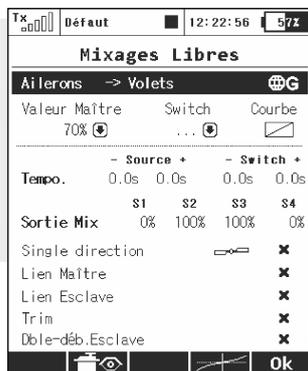
Réglez la „Sortie Mix” pour les colonnes „S1” et „S4” à 0%. Ce réglage ne permettra pas aux gouvernes de volet „S1” ou „S4” de se déplacer avec la fonction de mixage ailerons.
