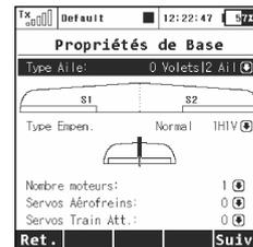
4. Sélectionnez le type d'aile. Dans l'exemple, nous avons 2 servos d'ailerons, sélectionnez „Type Aile” 0Volets/2 Ail. Ne modifiez pas les autres options de configuration, comme le type d'empennage, le nombre de moteurs, le nombre de servos d'aérofreins ou le nombre de servos du train d'atterrissage. Continuez en appuyant sur la touche „F5 (Suiv.ant)”.
