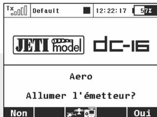
Il est possible de sélectionner un modèle différent immédiatement après démarrage de l'émetteur en pressant sur la **touche F3**. Pour rendre cet écran visible, vous devez sélectionner Enlever question au démarr. "Non" dans le menu **Système -> Configuration**.
