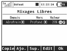
3. Pour modifier le mixage, il suffit de sélectionner la combinaison et d'appuyer sur la touche „F4 (Edit.er)” pour aller dans le menu avancé du mixage sélectionné.
