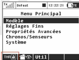
**Astuce:** Utilisez le verrouillage des gaz lorsque vous manipulez un modèle dont le système de propulsion est actif pour éliminer la possibilité d'activer accidentellement la manette des gaz et ainsi de démarrer le moteur de manière inattendue.
