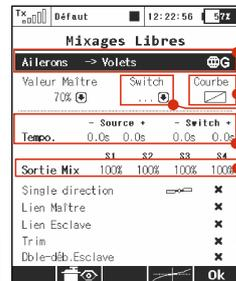
3. Pour modifier le mixage, il suffit de sélectionner la combinaison et d'appuyer sur la touche „**F4 (Edit.er)**” pour aller dans le menu avancé du mixage sélectionné.
