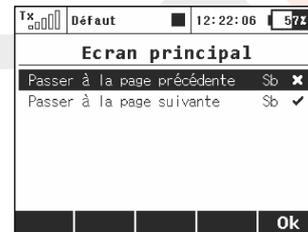
l'écran principal. Aller à **Chronos/Senseurs -> Ecran principal** et assignez deux interrupteurs séparés - le premier permettra toujours de retourner à la page précédente, le deuxième interrupteur permettra de passer à la page suivante. Vous pouvez également utiliser l'accéléromètre intégré en penchant l'émetteur (DS-16 uniquement) pour faire défiler les écrans de télémétrie différents.
