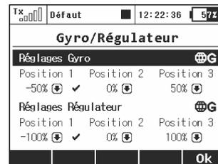
Ce menu vous permet de régler les paramètres pour ces deux voies. Les paramètres Gyro/Régulateur peuvent être réglés collectivement pour toutes les phases de vol en sélectionnant le
