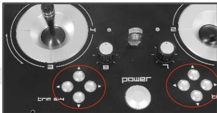
Les trims digitaux sont utilisés pour compenser finement votre modèle en vol. Quand l'émetteur est mis hors tension, les valeurs de trim sont stockées dans la mémoire et sont rappelées quand le système est de nouveau mis sous tension.
