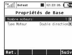
4. Le premier item dans le menu **„Propriétés de Base"** est le nombre de moteurs dans le modèle. Dans cet exemple, cet item ne sera pas sélectionné et nous irons directement au second item, qui est comment le moteur doit être commandé – par ex. si le moteur tourne dans un seul sens (single) ou dans les deux directions (double). Sélectionnez **„Type Moteur"** puis sélectionnez **„Double direction"**. Appuyer sur la touche **„F5 (Suiv.ant)"** pour confirmer.
