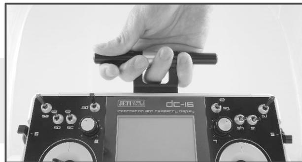
**Mise en garde:** Avant chaque session de vol et spécialement avec un nouveau modèle, il est important d'effectuer un essai de portée. Si vous utilisez un modèle avec un émetteur DC-16 ne faites pas écran et évitez tout contact de l'antenne émettrice avec votre corps. Cela pourrait augmenter la probabilité de problème de portée.
