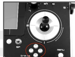
Les trims digitaux sont utilisés pour compenser finement votre modèle en vol. Quand l'émetteur est mis hors tension, les valeurs de trim sont stockées dans la mémoire et sont rappelées quand le système est de nouveau mis sous tension.
