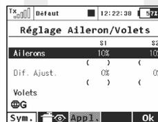
c). Dans la première ligne du menu, appuyez sur le „sélecteur de navigation 3D”, sélectionnez „Switch” et appuyez sur le „sélecteur de navigation 3D” encore une fois. Ensuite, actionner le „commutateur gachette (5)”. Confirmez avec la touche „F5 (OK)”. La dernière étape consiste à régler la valeur de course de laquelle vos ailerons vont se relever ou se baisser et de régler une compensation éventuelle à la profondeur.
