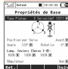
4. Sélectionnez le Type de plateau **„3 servos (def 120°)"**. Aller sur le second menu article **„Position par servo"** et changer pour **„Arrière"** – l'orientation du plateau tourne alors de 180°. Confirmez le changement en pressant sur la touche **„F5 (Suiv.ant)"**.
