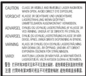
L'unité de réception de cet appareil fait partie des produits CLASS 3R LASER. Un rayonnement laser visible et invisible est émis lors de l'ouverture du boîtier protecteur du laser ; évitez donc toute exposition directe des yeux. Cette indication figure à l'extérieur, sous l'unité principale.
