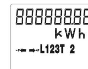
Défaut de branchement +P et -P
