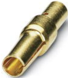
Contact à sertir, tournés, Contact unique, Diamètre de contact: 1 mm, Zone de sertissage: 0,14 mm²...0,56 mm²
