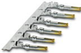
Contact à sertir, roulés, Contact unique, Diamètre de contact: 1 mm, Zone de sertissage: 0,22 mm²...0,56 mm²
