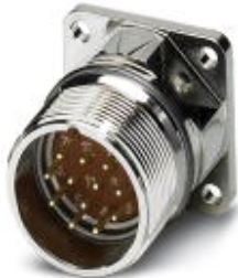
Connecteur d'appareil face avant, droit, Verrouillage à vis, M23, Nombre de pôles: 12, Type de contact: Connecteur mâle, raccordement serti, Joint torique axial, 4xØ3,2, blindé: oui
