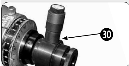
* Fig. 13b: avant d'utiliser pour la première fois le système d'éclairage du réticule, enlevez du porte piles l'élément isolant (Voir Fig. 13a).
