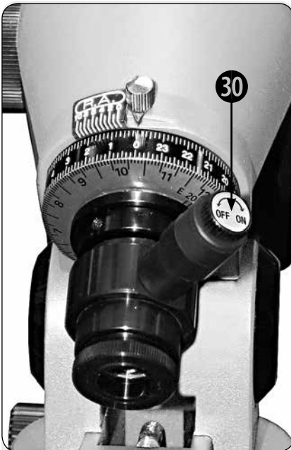
Fig. 21: viseur polaire. Détail
