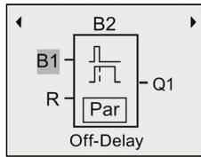
LOGO! connecte automatiquement l'entrée supérieure du nouveau bloc à B1, qui était jusqu'à présent connecté à Q1. Il est toutefois uniquement possible de connecter une entrée TOR avec une sortie TOR ou une entrée analogique avec une sortie analogique. Dans le cas contraire, LOGO! supprime l'ancien bloc.
