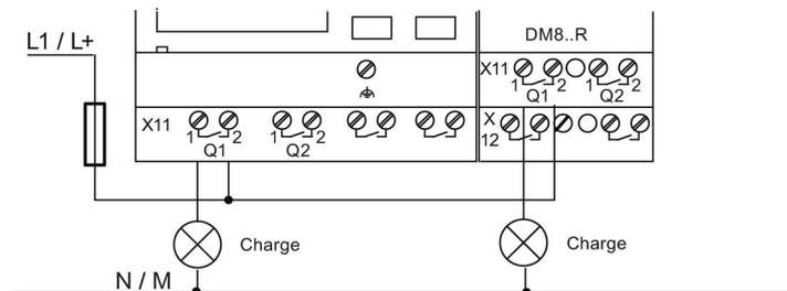
Protection avec disjoncteur automatique, max. 16A, caractéristiques B16, p. ex. : disjoncteur de puissance 5SX2 116-6 (si nécessaire)
