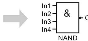
La sortie du bloc NAND est mise à 0 seulement si **toutes** les entrées sont mises à 1, c'est-à-dire si les contacts sont fermés.
