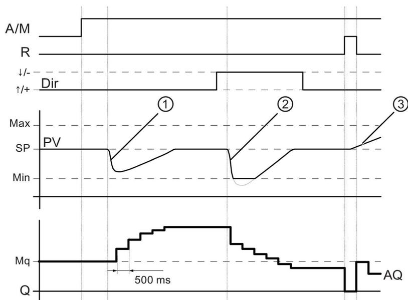
1. Une défaillance entraîne la chute de PV et comme Dir est paramétré sur haut, AQ augmente jusqu'à ce que PV corresponde de nouveau à SP.
