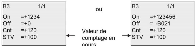
Vous pouvez modifier le seuil d'enclenchement et de déclenchement (On, Off). Cette action est impossible lorsque le seuil d'enclenchement ou de déclenchement est le résultat d'une autre fonction (dans la rubrique "Compteur/décompteur (Page 181)", il s'agit de B021).
