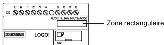
Pour les modules d'extension, vous pouvez utiliser les surfaces rectangulaires, par exemple pour le marquage des entrées et des sorties. Vous pouvez indiquer un facteur delta de +8 pour les entrées ou de +4 pour les sorties si le module LOGO! Base possède déjà 8 entrées ou 4 sorties.
