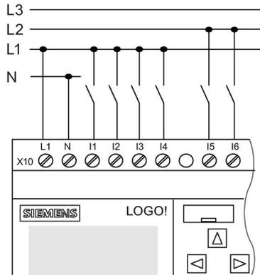
Les entrées de ces appareils sont regroupées en 2 groupes de 4 entrées chacun. Différentes phases sont uniquement possibles entre les blocs, pas au sein des blocs.
