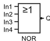
La sortie du bloc NOR prend uniquement l'état 1 si **toutes** les entrées sont mises à 0, c'est-à-dire sont désactivées. Aussitôt qu'une entrée est activée (état logique 1), la sortie du bloc NOR est mise à 0.
