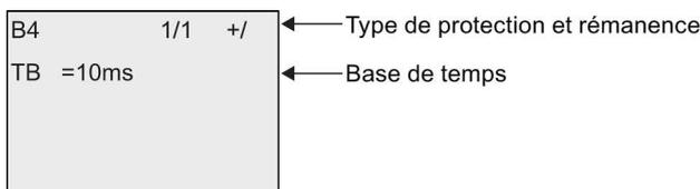
Pour changer la base de temps, appuyez sur ► et déplacez le curseur sur "10ms". Appuyez sur OK et sélectionnez la base de temps. Appuyez sur ▲ ou ▼ pour sélectionner une autre base de temps. Pour confirmer la sélection, appuyez sur OK.
