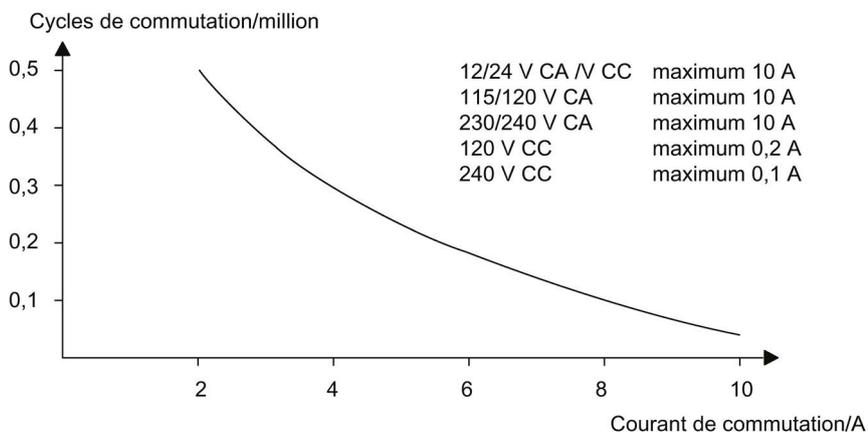
Caractéristiques de commutation et durée de vie des contacts en présence d'une forte charge inductive selon CEI 947-5-1 DC 13/AC 15 (contacteurs, bobines magnétiques, moteurs) :
