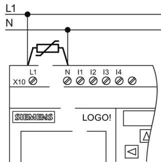
En cas de crêtes de tension, utiliser une varistance (MOV) dont la tension de fonctionnement est supérieure d'au moins 20% à la tension nominale.
