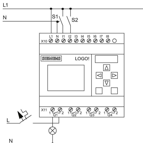
Le commutateur S1 agit sur l'entrée I1 et le commutateur S2 sur l'entrée I2. La charge est connectée au relais Q1.
