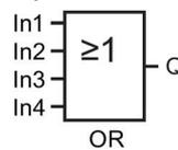
La sortie de l'élément OR est mise à 1 seulement si **au moins une** entrée est mise à 1, c'est-à-dire qu'au moins l'un des contacts est fermé.
