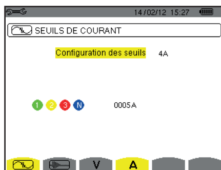
Figure 29 : l'écran Seuils de courant dans le menu Mode transitoire
