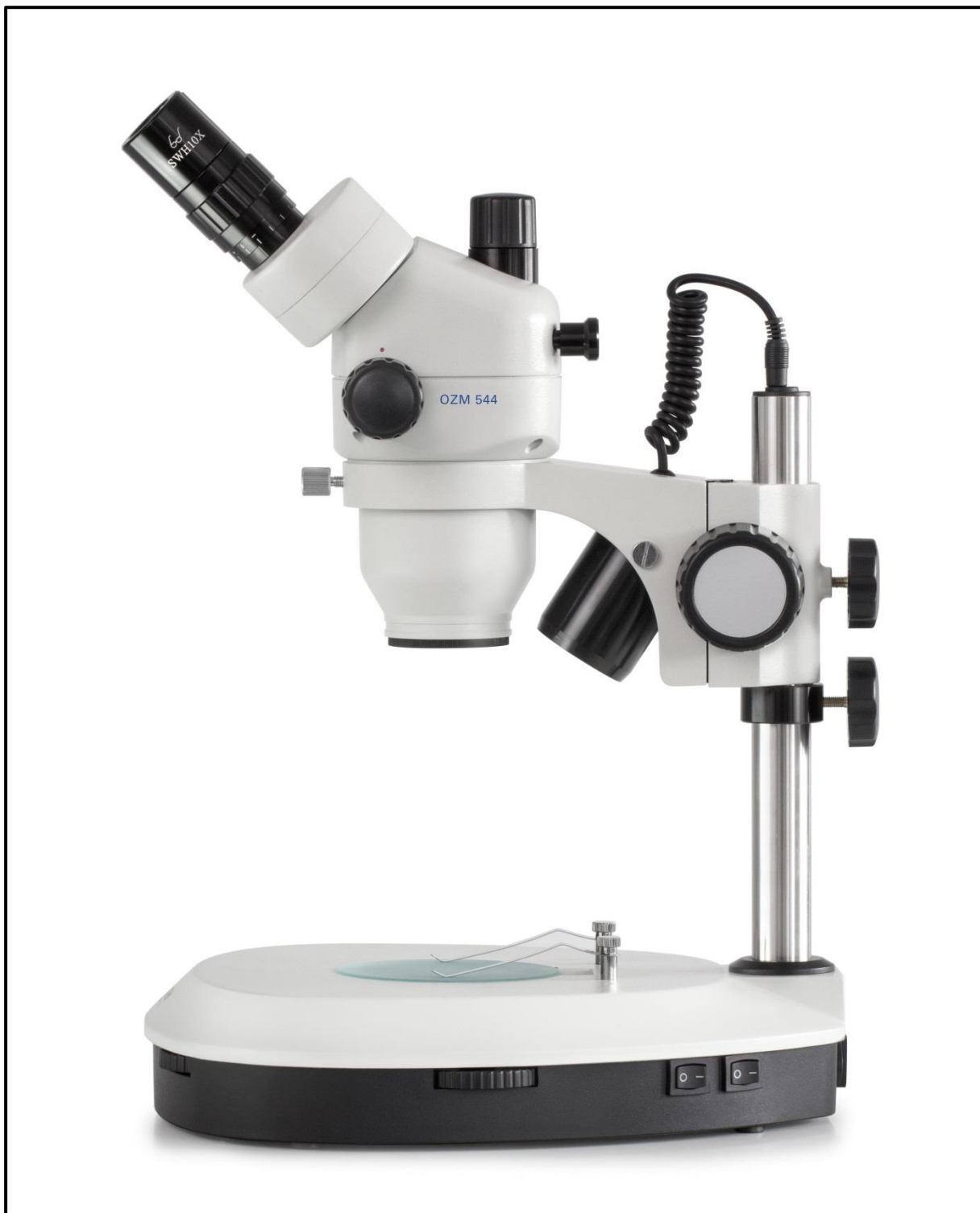
Microscope stéréo à zoom entièrement monté
