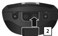
Si **aucun** kit oreillette n'est branché, insérer le couvercle en caoutchouc fourni **2** afin d'assurer la protection contre les projections d'eau.
