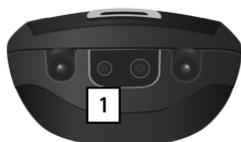
Vous pouvez raccorder un kit oreillette sous le téléphone à l'aide d'une prise de 2,5 mm **1**. Des recommandations sur les kits oreillette sont disponibles sur la page relative à l'appareil sur [www.gigaset.com](http://www.gigaset.com).
