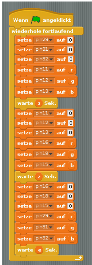
Le programme 21rgb3 pilote l'effet lumineux sur trois DEL RVB
