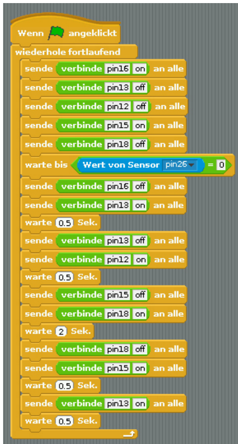
Le programme 12fussgaengerrot pilote un feu pour piétons avec DEL RVB
