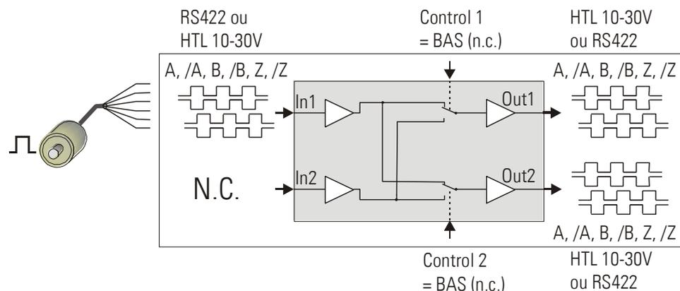
Le codeur est relié à l'entrée 1 tandis que l'entrée 2 reste déconnectée. L'entrée peut être réglée soit au format A, /A, B, /B, Z, /Z, soit au format A, B, Z (niveau TTL / RS422 ou HTL 10-30V).
