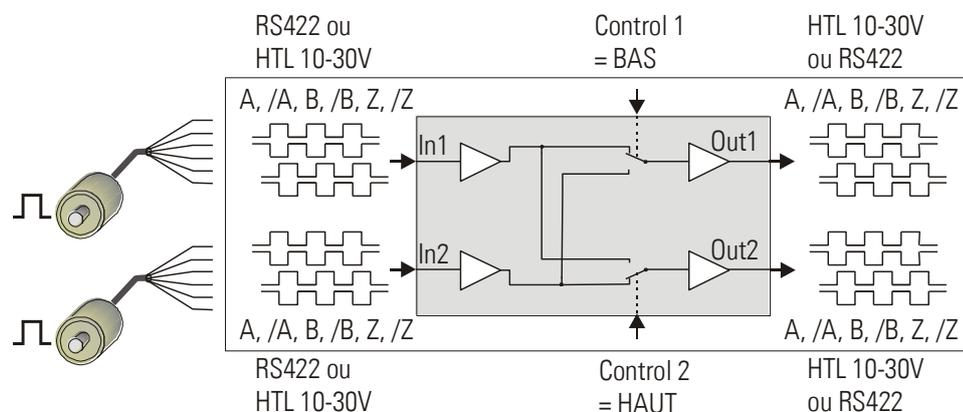
Les deux entrées peuvent être réglées individuellement soit au format A, /A, B, /B, Z, /Z, soit au format A, B, Z (niveau TTL / RS422 ou HTL 10-30V).
