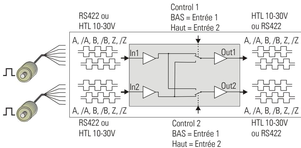
Les deux entrées peuvent être réglées individuellement soit au format A, /A, B, /B, Z, /Z, soit au format A, B, Z (niveau TTL / RS422 ou HTL 10-30V).
