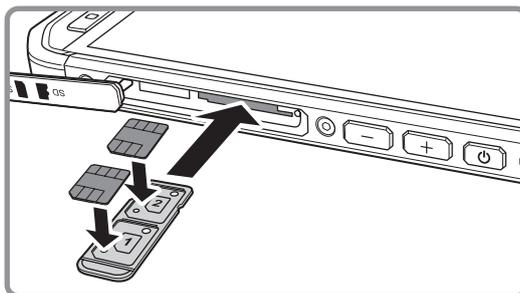
4. Insérez le plateau SIM dans l'encoche SIM.
