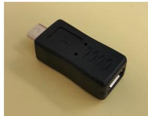
Figure 18 : Inverseur de connecteur Android #2
