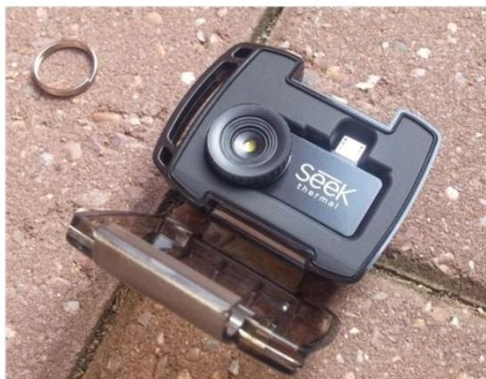
Figure 74 : Boîtier de transport imperméable à l'eau (ouvert)
