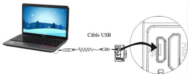
Connecter la caméra à l'ordinateur pour le chargement, l'indicateur de chargement devient bleu, et il s'éteint quand le chargement est terminé. En général, une charge complète de la batterie prend 2-4 heures.
