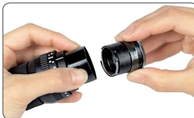
6. Pour orienter les réticules, tournez l'oculaire dans le tube.
