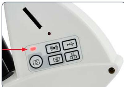
4. Si un bouton de mode autre que celui du mode Ethernet est allumé en vert, appuyez sur le bouton du mode Ethernet et attendez que la diode témoin et le bouton du mode Ethernet soient tous les deux verts.
