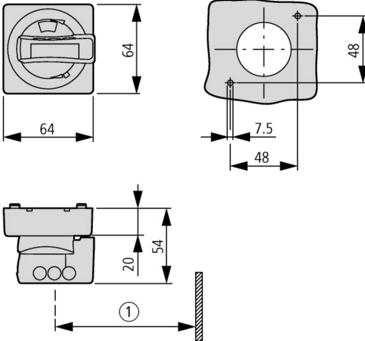
Profondeur de montage : 125 à 240 mm du bord supérieur du profilé chapeau DIN au bord de la porte d'armoire ou du couvercle
