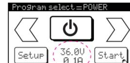
Dans ce menu «Power», le chargeur affiche les différents paramètres défini par l'utilisateur lors d'une utilisation précédente. Si vous n'avez pas besoin de modifier ces paramètres, sélectionner le bouton «Start» pendant plus de 2 secondes..
