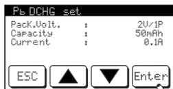
L'écran affiche ensuite les différents paramètres en cours de la charge / décharge. Pour arrêter ce processus sélectionner le bouton «ESC».
