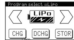
1/ choisir le type de batterie puis sélectionner «CHG» ou «DCHG» ou «Storage» pour accéder à l'interface pour définir les paramètres de charge
