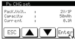
**Mode Décharge Pb:** Ce mode est pour décharger une batterie Plomb. L'affichage permet de régler la tension, la capacité et le courant de décharge souhaité pour votre batterie. Ce courant de décharge peut aller de 0,1A à 5A. Pour lancer la décharge, presser le bouton «Enter» plus de 2 secondes.
