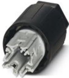
Écrou QUICKON, noir, 4 pôles +PE, 1,0 mm 2 à 2,5 mm 2 / 690 V / 20 A, pour lignes de diamètre 6 mm à 11 mm.
