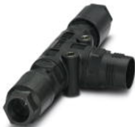
Répartiteur en T QUICKON, noir, 4 pôles + PE, 1,0 mm² ... 2,5 mm² / 690 V / 20 A, pour diamètre de câble 9 mm ... 16 mm, avec deux écrous Quickon
