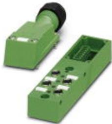
Répartiteur pour capteurs/actionneurs, Application : Standard, Type de raccordement: Connecteur femelle M8 Métal, Nombre de prises: 4, Nombre de pôles: 3, Détrompage: A - standard, Affectation des prises: simple, Affichage d'état: Oui, pnp; Racc. câble multicond.: Raccordement vissé enfichable 180°, Blindage: non
