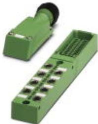
Répartiteur pour capteurs/actionneurs, Application : Standard, Type de raccordement: Connecteur femelle M8 Métal, Nombre de prises: 8, Nombre de pôles: 3, Détrompage: A - standard, Affectation des prises: simple, Affichage d'état: Oui, pnp; Racc. câble multicond.: Raccordement vissé enfichable 180°, Blindage: non
