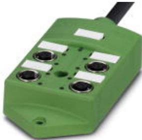
Répartiteur pour capteurs/actionneurs, Application : Standard, Type de raccordement: Connecteur femelle M12 SPEEDCONNEC Métal, Nombre de prises: 4, Nombre de pôles: 5, Détrompage: A - standard, Affectation des prises: double, Affichage d'état: Oui, pnp; Racc. câble multicond.: Connexion fixe 180°, PUR/PVC, Longueur de câble: 10 m, Blindage: non
