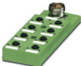
Répartiteur pour capteurs/actionneurs, Application : Standard, Type de raccordement: Connecteur femelle M12 Plastique, Nombre de prises: 6, Nombre de pôles: 5, Détrompage: A - standard, Affectation des prises: double, Affichage d'état: Oui, pnp; Racc. câble multicond.: Raccordement enfichable M23 90°, Blindage: non
