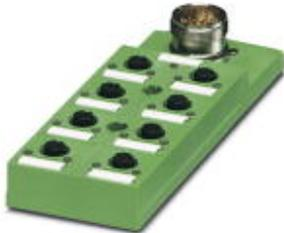
Répartiteur pour capteurs/actionneurs, Application : Standard, Type de raccordement: Connecteur femelle M12 Plastique, Nombre de prises: 8, Nombre de pôles: 5, Détrompage: A - standard, Affectation des prises: double, Affichage d'état: Oui, pnp; Racc. câble multicond.: Raccordement enfichable M23 90°, Blindage: non
