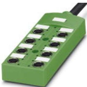
Répartiteur pour capteurs/actionneurs, Application : Standard, Type de raccordement: Connecteur femelle M12 SPEEDCONNNEC Métal, Nombre de prises: 8, Nombre de pôles: 5, Détrompage: A - standard, Affectation des prises: double, Affichage d'état: Oui, pnp; Racc. câble multicond.: Connexion fixe 180°, PUR/PVC, Longueur de câble: 5 m, Blindage: non
