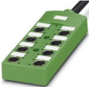
Répartiteur pour capteurs/actionneurs, Application : Standard, Type de raccordement: Connecteur femelle M12 SPEEDCONNEC Métal, Nombre de prises: 8, Nombre de pôles: 5, Détrompage: A - standard, Affectation des prises: double, Affichage d'état: Oui, pnp; Racc. câble multicond.: Connexion fixe 180°, PUR/PVC, Longueur de câble: 10 m, Blindage: non
